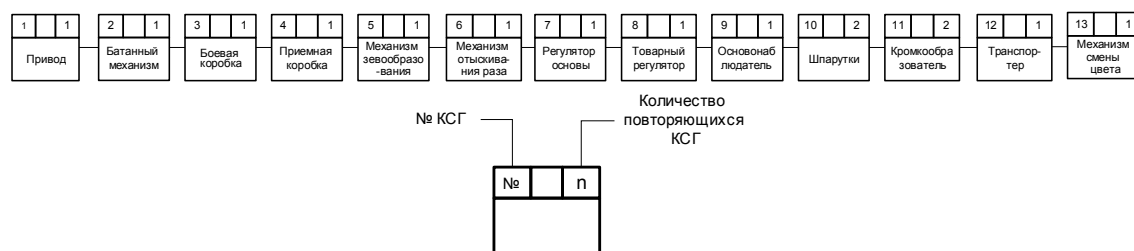
Рис. 1. Конструкторско-структурная схема ткацкого станка СТБ-180
